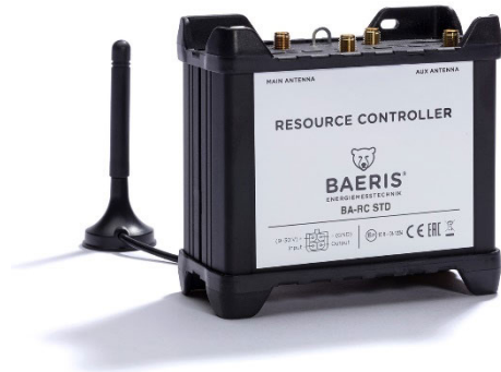
BA-RC STD – Resource Controller Standard: Die BAERIS Schaltzentrale für sparten- und herstellerübergreifende Zählerauslesung
